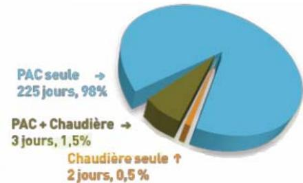
EN PROJET NEUF, on préconise un appoint systématique en aérothermie si la pompe à chaleur est la seule source de chauffage. D'une part, l'appoint aide la pompe à chaleur dans les moments de grand froid et d'autre part elle assure un confort minimum en cas de panne de la pompe à chaleur.
