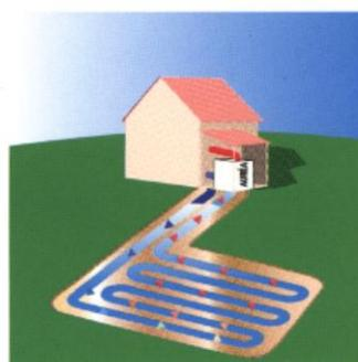
Captage des calories du sol par capteurs enterrés horizontaux.
